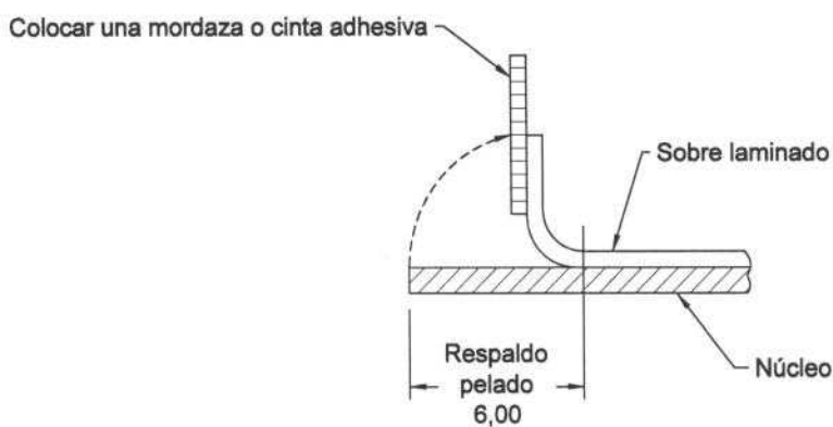
Figura 10. Preparación de la probeta para los ensayos de adherencia
